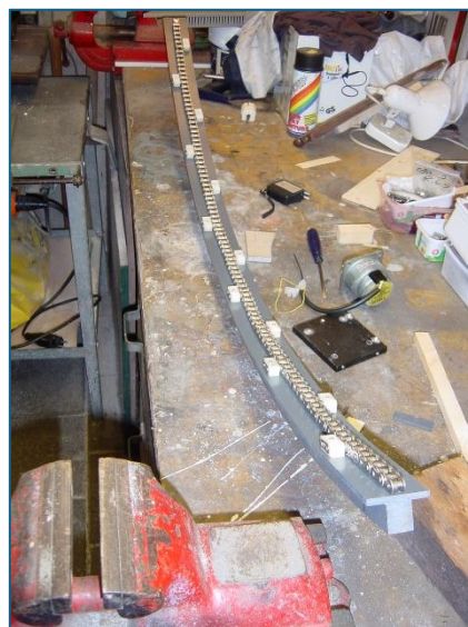
Figuur 26: RVS Transportketting voor koepelsluis
