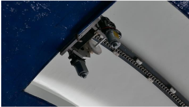
Figuur 27: Zelfbouw vertrackingskast met motoren
