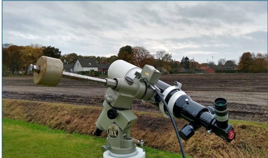
Figuur 20: Zonneprisma (rood) met oculair en filters achter de kijker.
